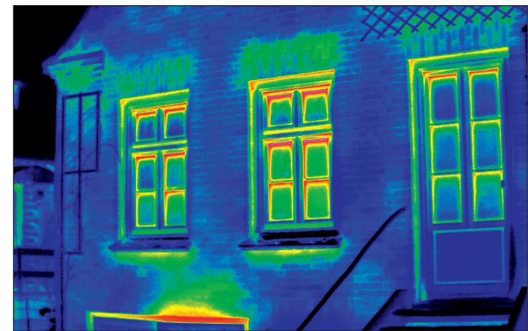
Mit der Spezialkamera wird erkennbar, an welchen Stellen des Gebäudes Wärme nach außen gelangt Foto: SWS
